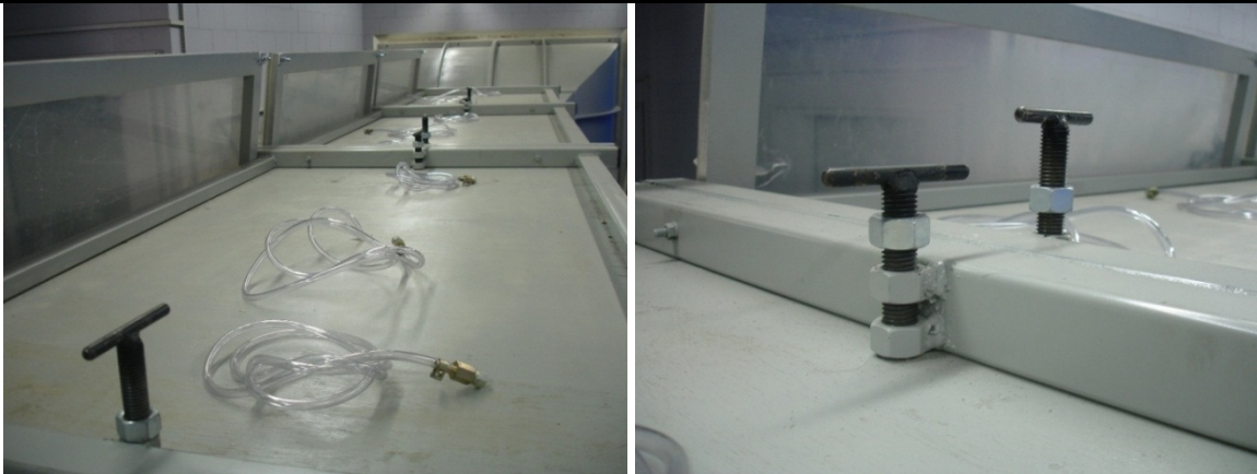
Figura 4: (a) Vista geral do teto do túnel de vento, onde se observa as mangueiras para as tomadas de pressão estática e os parafusos para ajustar o teto móvel; (b) Detalhe de dois parafusos do teto móvel.
